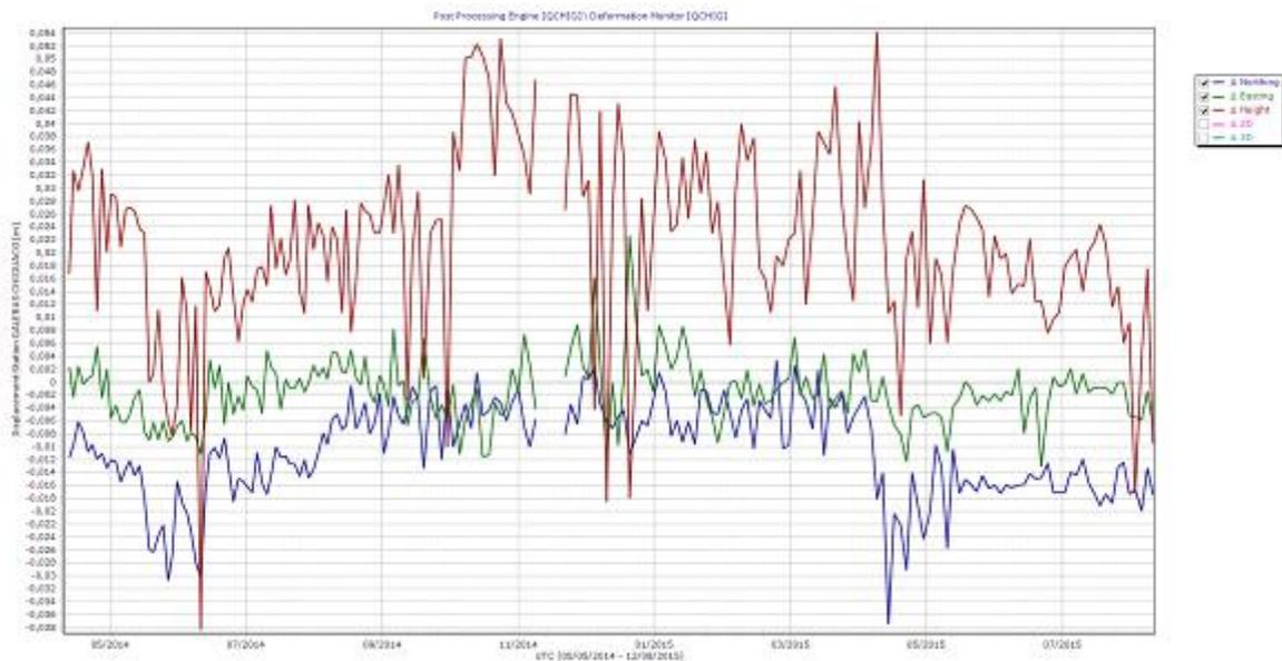
**Figura 22.** Variaciones en las direcciones Norte, Este y Altura de la estación GNSS Chiguaco instalado en Galeras, para el periodo comprendido entre mayo de 2014 y el 13 de agosto de 2015.
