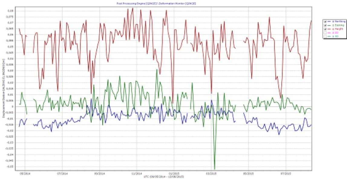
**Figura 24.** Variaciones en las direcciones Norte, Este y Altura de la estación GNSS El Ingenio instalada en Galeras, para el periodo comprendido entre el 9 de mayo de 2014 y el 13 de agosto de 2015.
